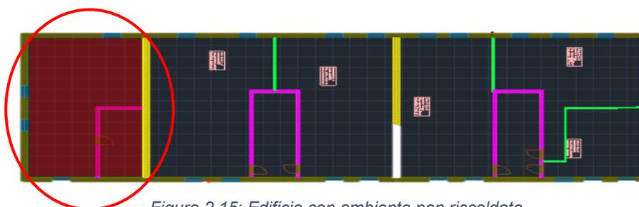
Figura 2.15: Edificio con ambiente non riscaldato
