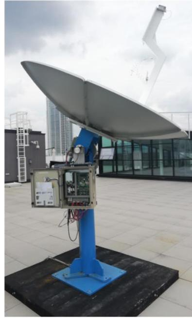
*Figura 37 Collettore solare a disco realizzato dall'Electronic Machining S.r.l. e posizionato sul tetto dell'Energy Center.*
