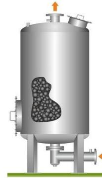
Figura 43 – Immagini relative ad un sistema di filtrazione a carboni attivi (Fonte: Conveco);
