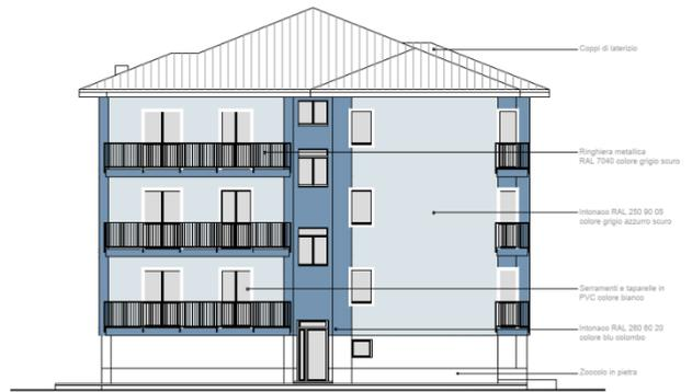
Pianta 10: Prospetto Est e Prospetto Ovest
