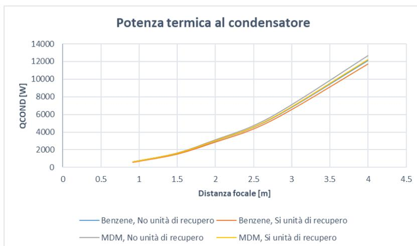
Figura-76 Flusso termico richiesto dal condensatore
