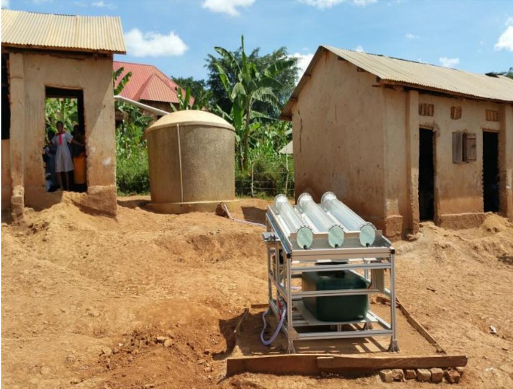
Figura 83 - Trattamento SODIS dell'acqua piovana raccolta in una cisterna utilizzando i reattori HWR nel 2019 (CORDIS, 2020)
