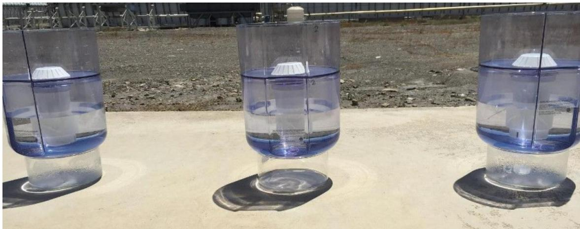
*Figura 86 - Unità di filtrazione dell'acqua in ceramica (WATERSPOUT, 2022)*
