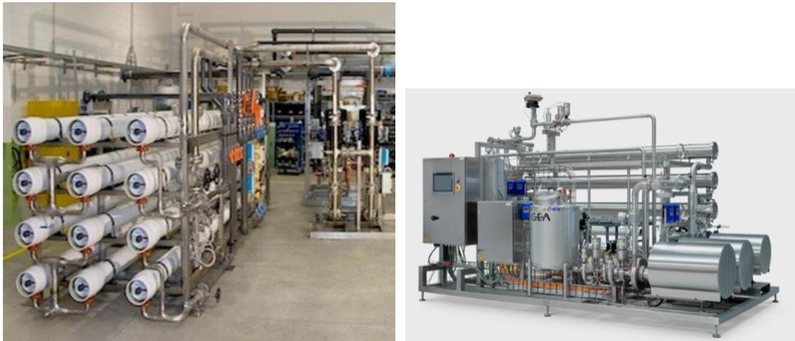
Figura 3.1: Impianto di demineralizzazione per la produzione di acqua potabile (sx), impianto di dealcolizzazione per la produzione di birra (dx). Immagini tratte rispettivamente da [www.membrane.it](http://www.membrane.it) e da [www.gea.com](http://www.gea.com)
