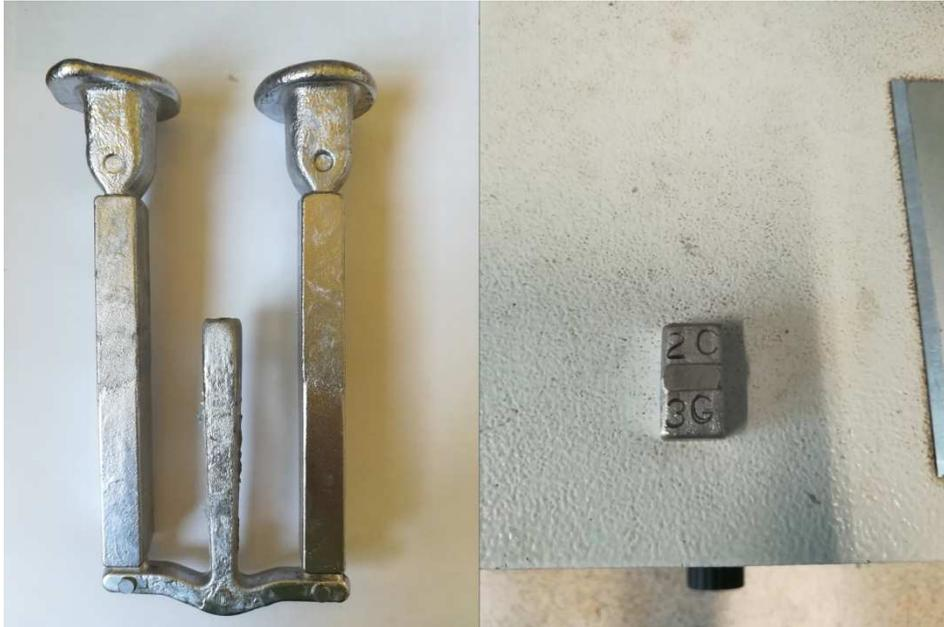
Figura 12 A sinistra risultato di un getto colata doppia FGM, a destra esempio di campione tratto dalla sezione di un lingotto di colata.
