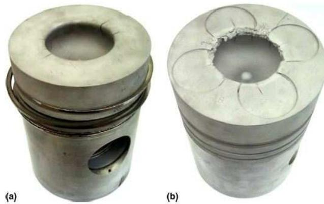
**Figura 1 Esempio di cricche superficiali originate da fatica termica in due pistoni per motori diesel<sup>3</sup>.**
