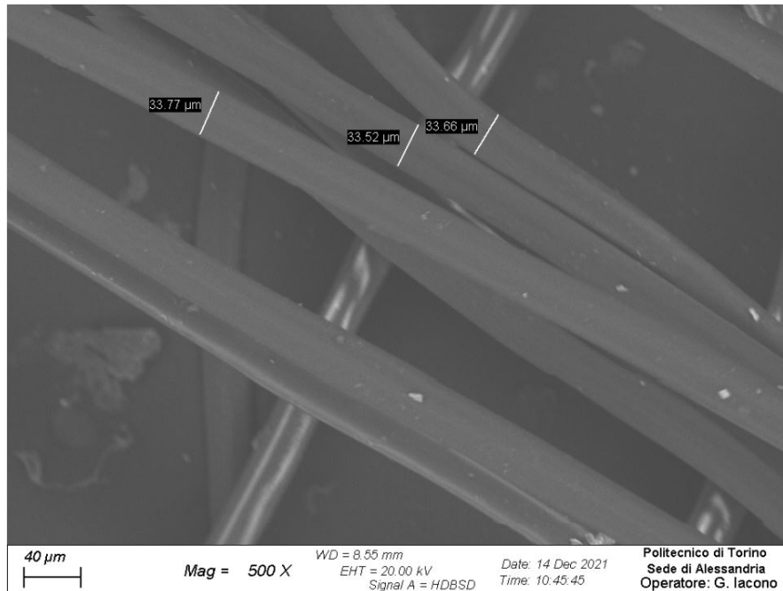
Figura 4.3: Immagine SEM fibre di rPET provenienti dalle cinture
