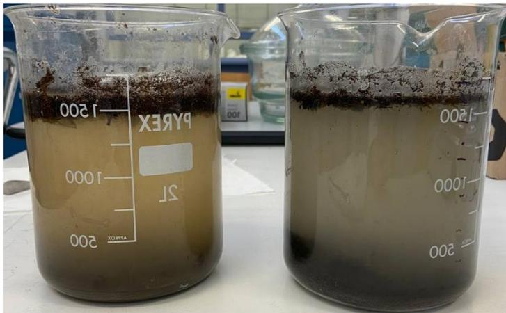
Figura 25- campione 1, campione 2 separati per densità (approccio 2)
