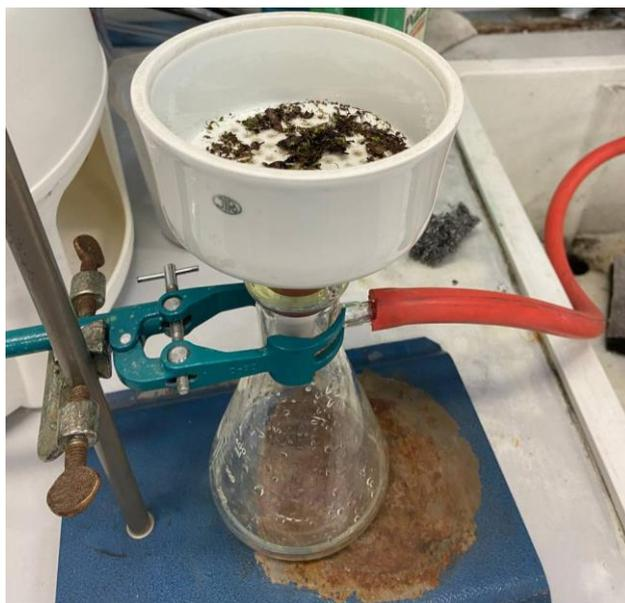
*Figura 23- filtrazione con filtro di carta e sistema a vuoto*
