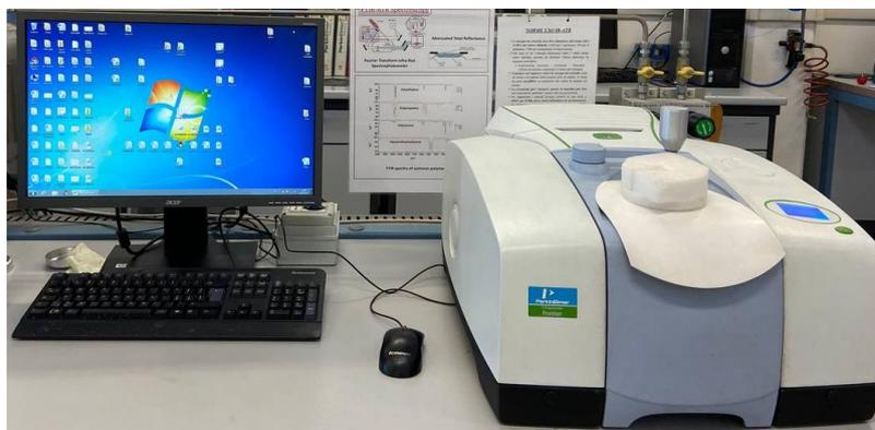
Figura 15- spettrometro IR, Frontier Spectrometer- Perkin Elmer
