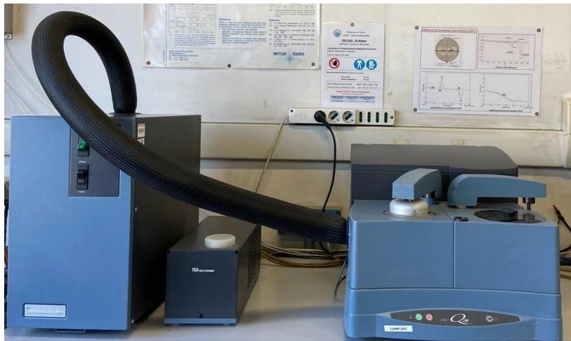
Figura 14 strumento DSC Q20
