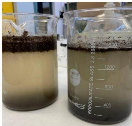
*Figura 22- campione 1, campione 2 separati per densità (approccio 1)*
