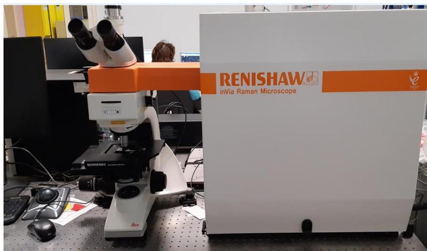
Figura 16- Spettrometro Raman, inVia Renishaw
