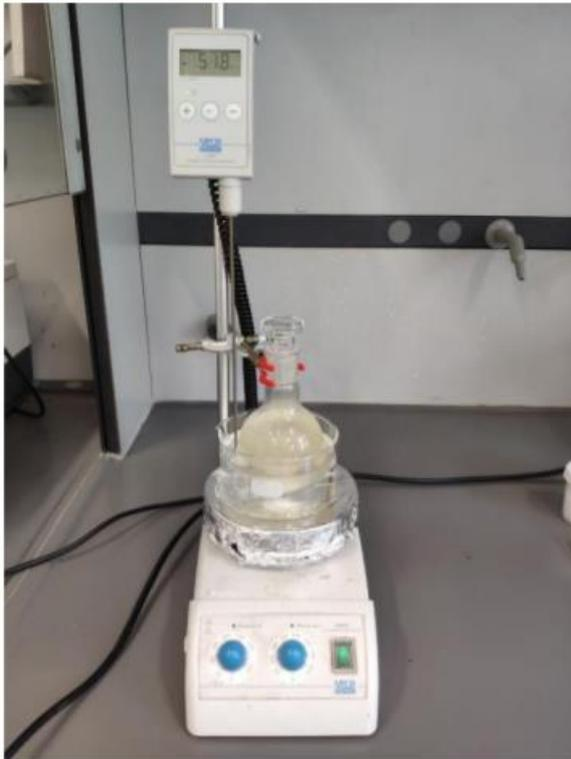
*Figura 3. 2: setup della reazione di metacrilazione della gelatina<sup>4</sup>*
