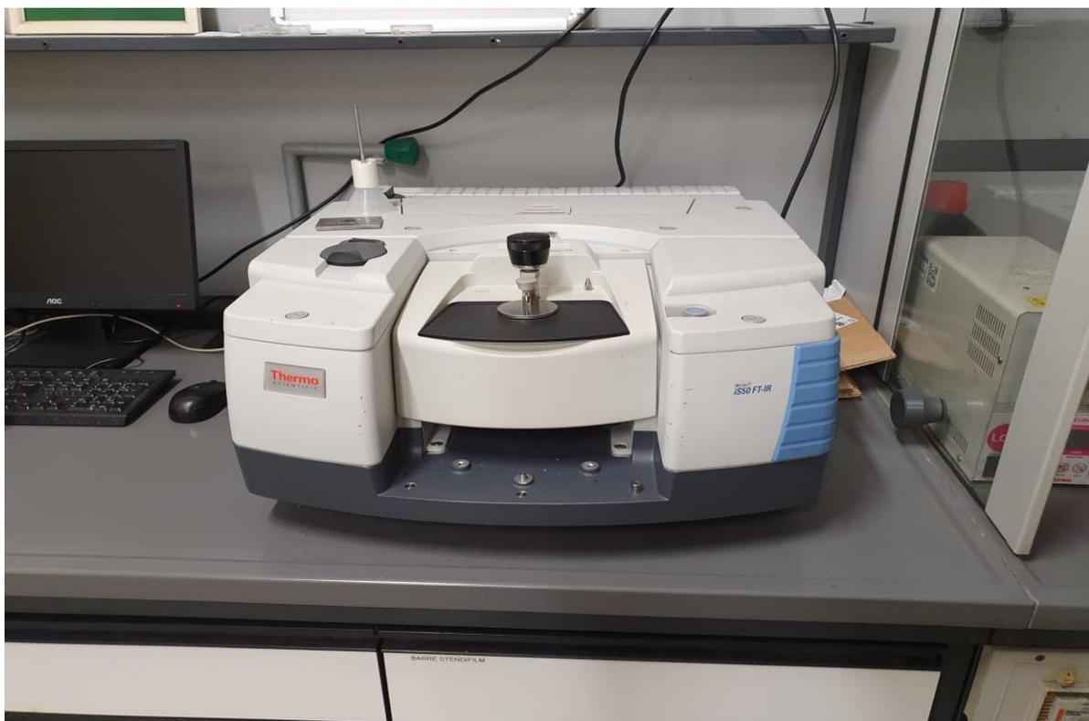
Figura 3.12: spettrometro Nicolet iS50 FT-IR di Thermo-Scientific
