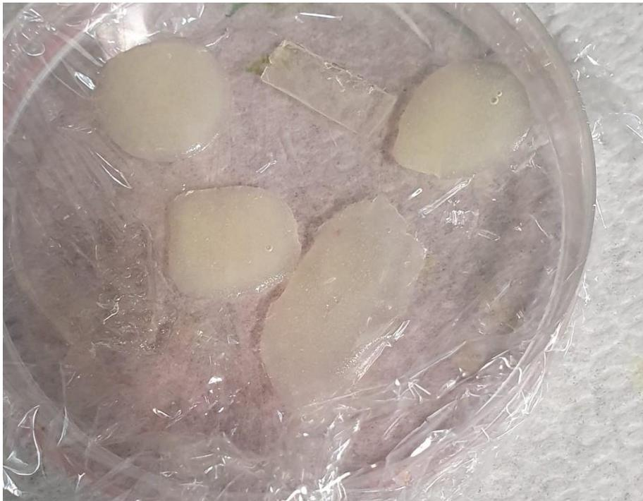
*Figura 3. 11: film di TEGORAD dopo la reazione di fotoreticolazione*
