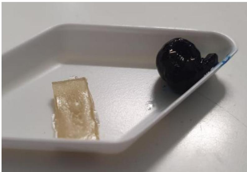
Figura 4. 12: hydrogel di GelMA prima (a sinistra) e dopo (a destra) l'adsorbimento di MB
