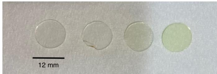
**Figura 63** - Campioni di vetro attivo con concentrazioni crescenti (da sinistra verso destra) di ioni  $\text{Pr}^{3+}$  (Pr1, Pr2, Pr3 e Pr4).
