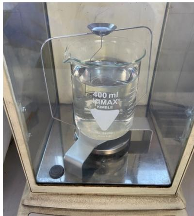
**Figura 59** - *Set-up* utilizzato per la misura di densità.
