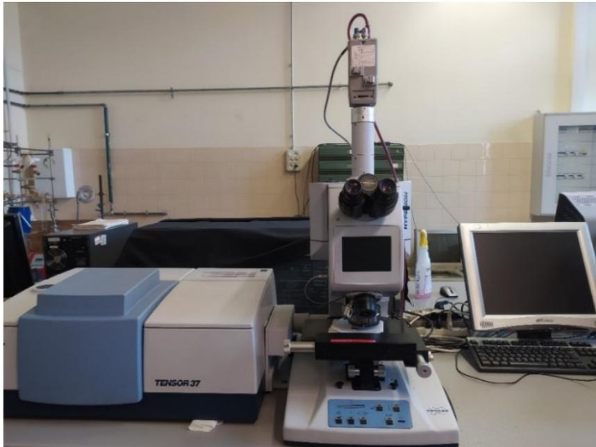
**Figura 5.1** – Sistema di analisi composto da spettrometro Tensor 37 e microscopio Hyperion 2000
