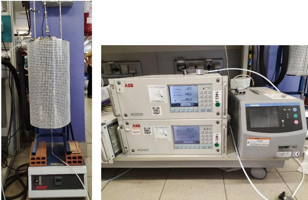
**Figura 3.9** Forno verticale a temperatura programmabile (sinistra) e analizzatori di flusso (destra).
