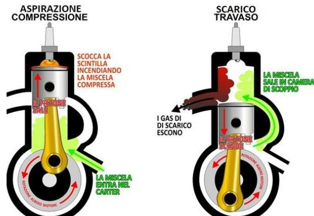
Figura 1.4 Schema rappresentativo del meccanismo del motore a due tempi[11].
