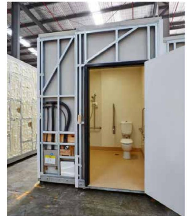
Cellula bagno completa senza isolamento esterno, di Sync
