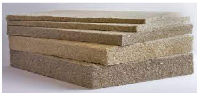
Fig. 3\_Vari formati di pannelli isolanti in canapa
