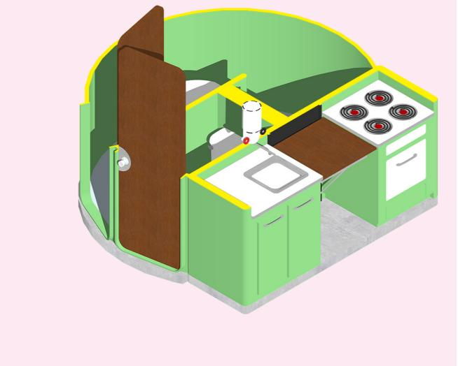
elemento prefabricado que contiene los servicios y las instalaciones
