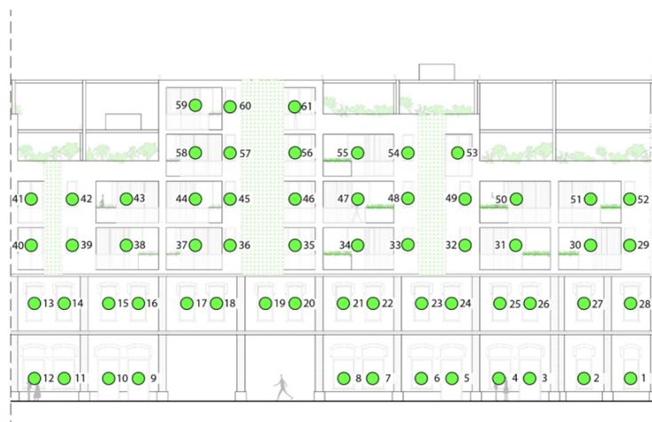
Fig. 7 Schema in prospetto e sezione dei ricevitori  $R_A$ .
