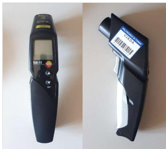
Figura 104. Termometro ad infrarossi (IR), modello "Testo 830-T2", utilizzato nel corso dell'indagine termometrica.
