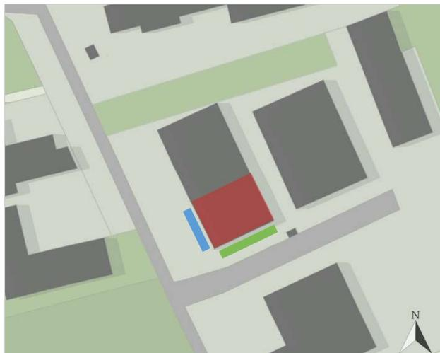
Figura 114. Estratto di planimetria con individuazione delle pareti soggette a rilevazione della temperatura.
