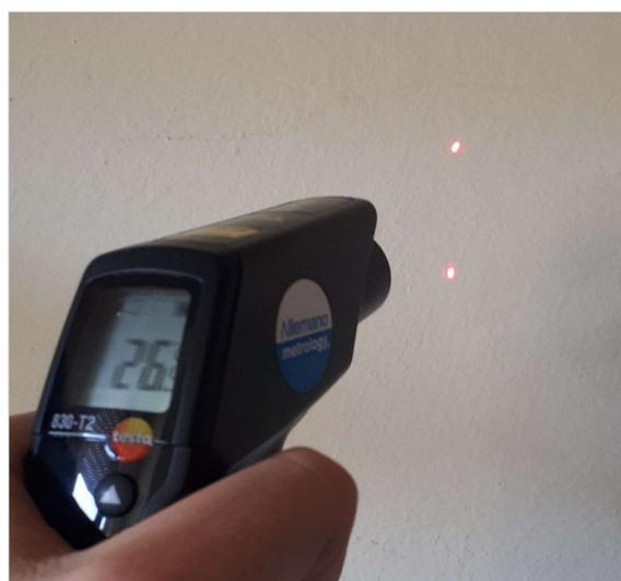
*Figura 105. Termometro ad infrarossi (IR), modello "Testo 830-T2". Raggi laser proiettati su una superficie.*
