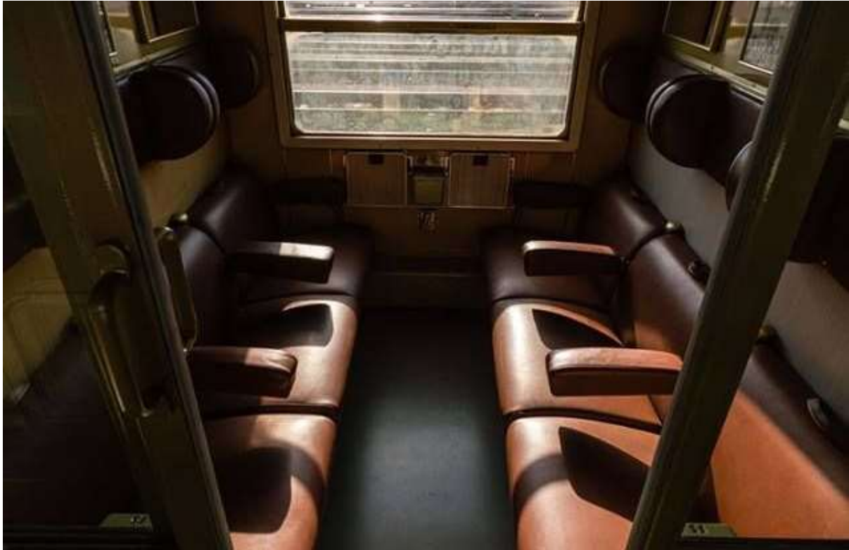
Carrozza tipo UIC-X scompartimento della seconda classe
