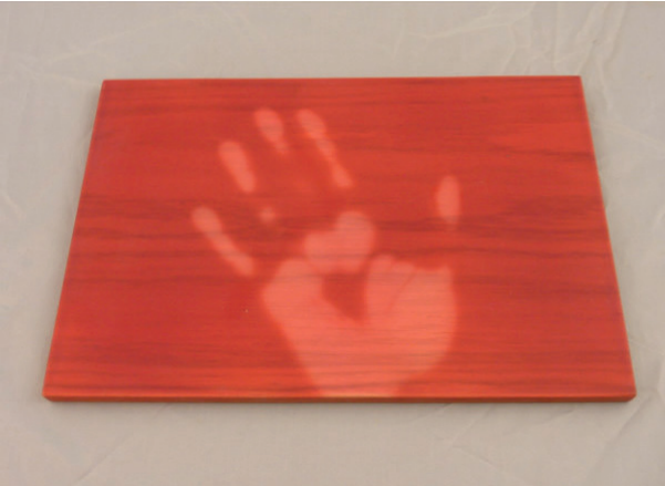
In condizioni normali, la vernice ha un colore uniforme, ma quando si registra una variazione di temperatura in una zona, questa cambia colore
