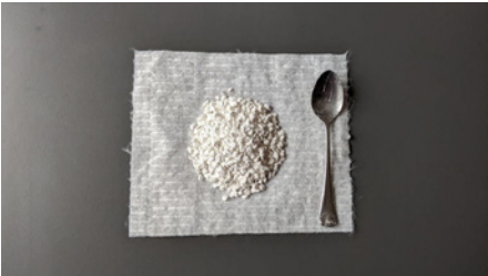
1. preparazione delle quantità di calce (120g)
