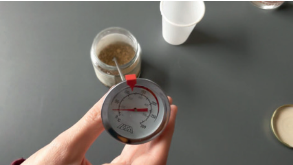
La zeolite naturale non produce calore
