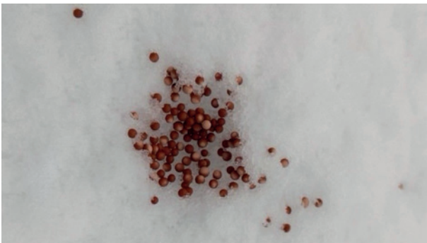
La zeolite assorbe la neve, scavando progressivamente un solco. Catturando l'acqua diventa più scura
