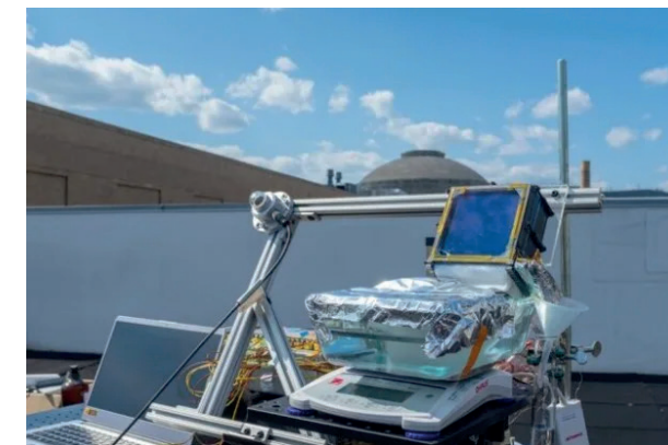
Il dispositivo di dissalazione solare elaborato dal MIT
