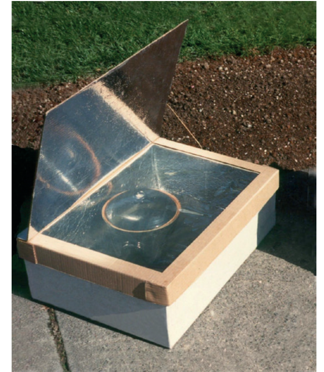
Box cooker DIY realizzato con una scatola di cartone, specchi e una pentola di colore scuro
