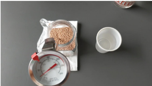
2. Aggiunta dell'acqua sulla zeolite
