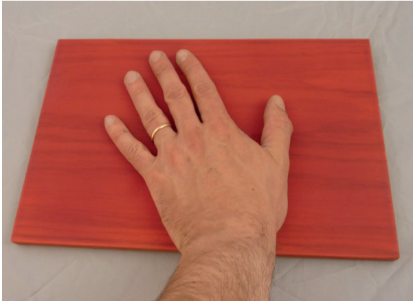
La vernice termocromica reagisce al cambio di temperatura.
