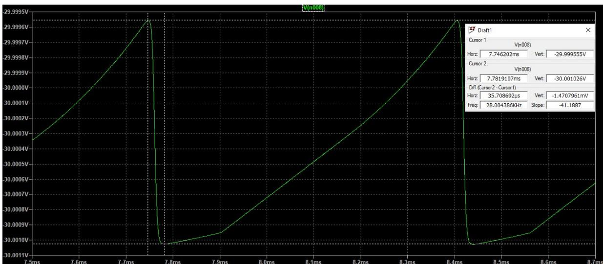
Figura 4.10: Ripple della tensione in uscita
