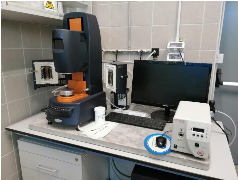
Figura 21: Reometro rotazionale DHR-2 utilizzato per le analisi
