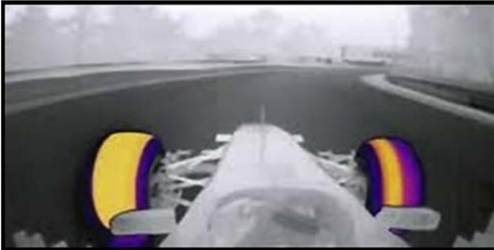
Figura 3.2 Immagini termografiche degli pneumatici di un'auto da corsa [47]
