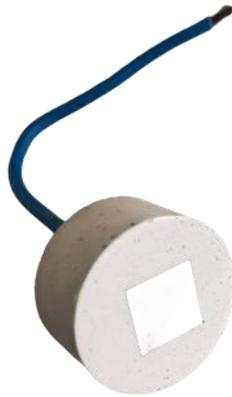
Figura 2. 7 Campione inglobato nella resina tricomponente Demotec 10 previa applicazione dell'elettrodo.
