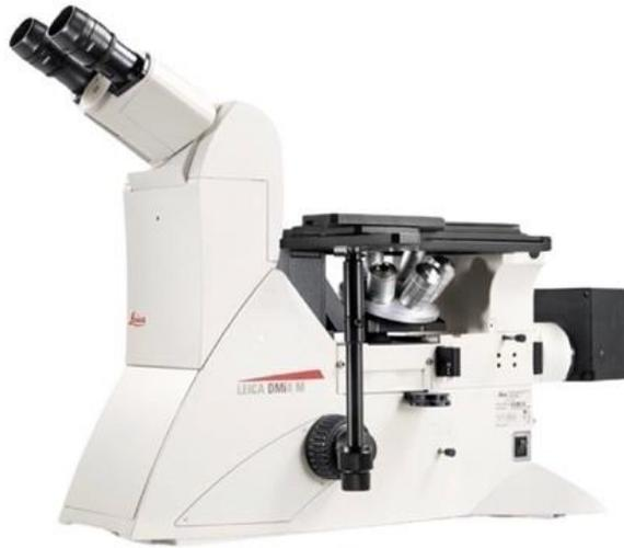
*Figura 2. 4 Microscopio ottico Leica DMI 5000M.*
