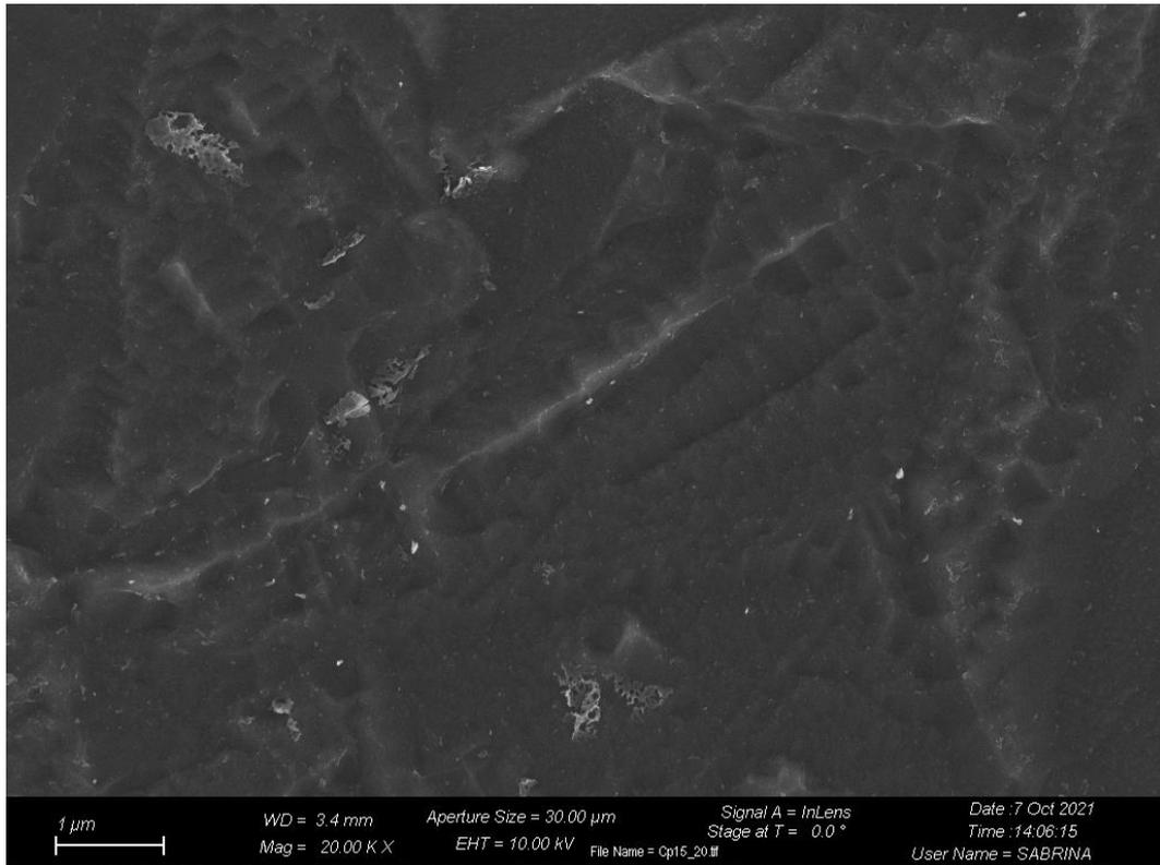
*Figura 3. 8 Immagine acquisita mediante il microscopio elettronico della superficie perpendicolare alla direzione di fabbricazione del campione prodotto impostando il set di parametri di stampa D.*
