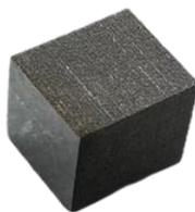
Figura 2. 1 Campione in Ti-CP di dimensioni 10 mm x 10 mm x 12 mm fabbricato mediante SLM.
