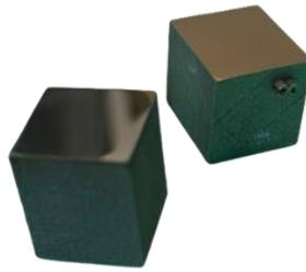
*Figura 2. 3 Lucidatura a specchio delle superfici dei campioni destinati alle analisi morfologiche e microstrutturali. A sinistra è raffigurata la lucidatura della superficie perpendicolare alla direzione di stampa del campione mentre a destra quella parallela.*
