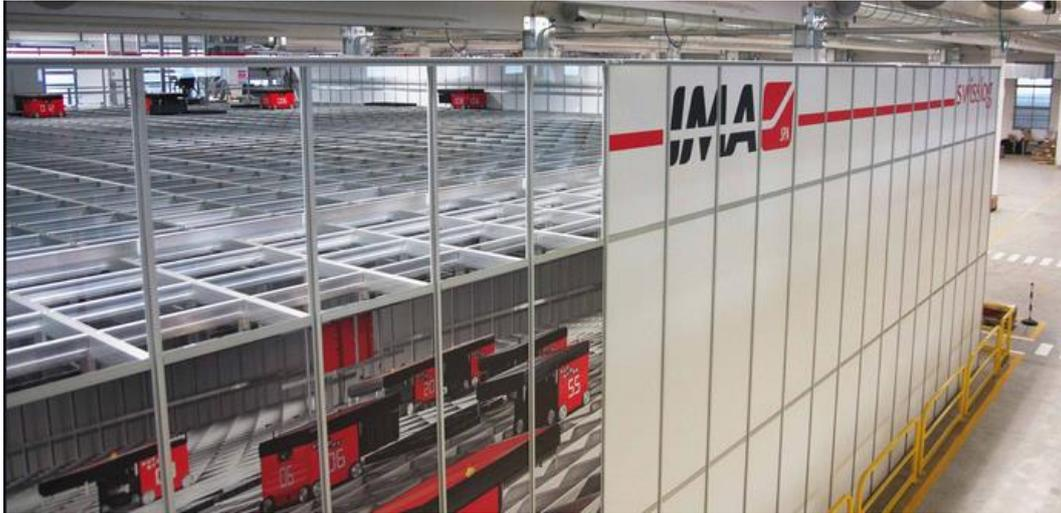
*Figura 10 – AutoStore per lo stoccaggio di UdC di piccole dimensioni [11]*
