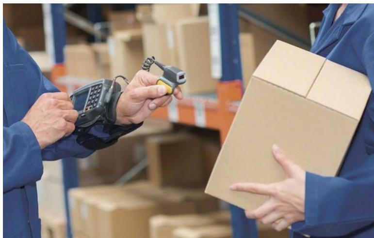
*Figura 21 - Dispositivo indossabile collegato ad uno scanner ad anello [25]*
