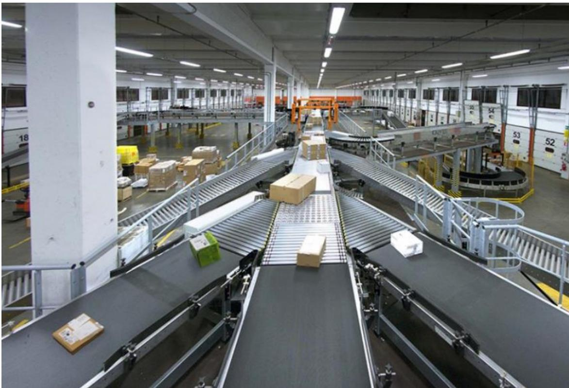
Figura 22 – Sistema automatico di sorting [26]
