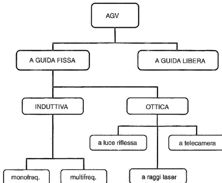
Figura 12 - Classificazione dei sistemi di guida degli AGV (Monte, 2009)
