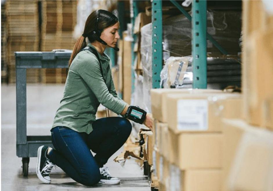
*Figura 18 – Operatrice che utilizza il sistema di Voice Picking [23]*
