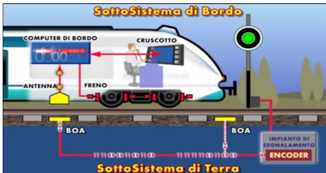
Figura 2.6: Rappresentazione schematica sottosistema di bordo e terra Hitachi Rail STS
