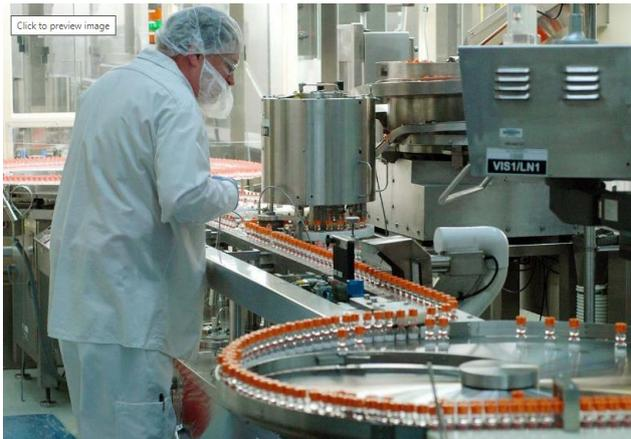
Figura 9: Linea di riempimento delle fiale, sito produttivo Pfizer a Kalamazoo [52]
