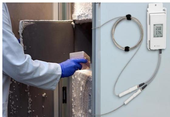
Figura 26: Data logger collegato al freezer [69]
