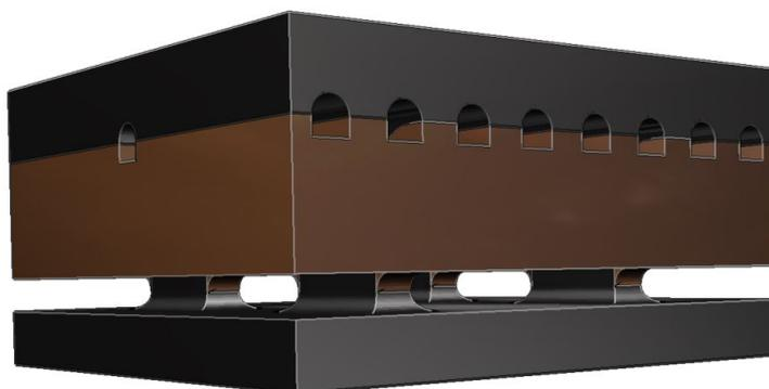
Figura 5.10: Rendering dell'evaporatore con archi a struttura integrata
