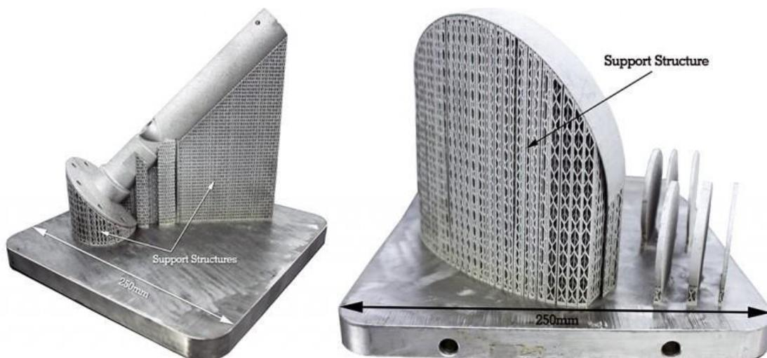
Figura 3.18 Esempio di utilizzo di strutture di supporto in pezzi metallici [21]
