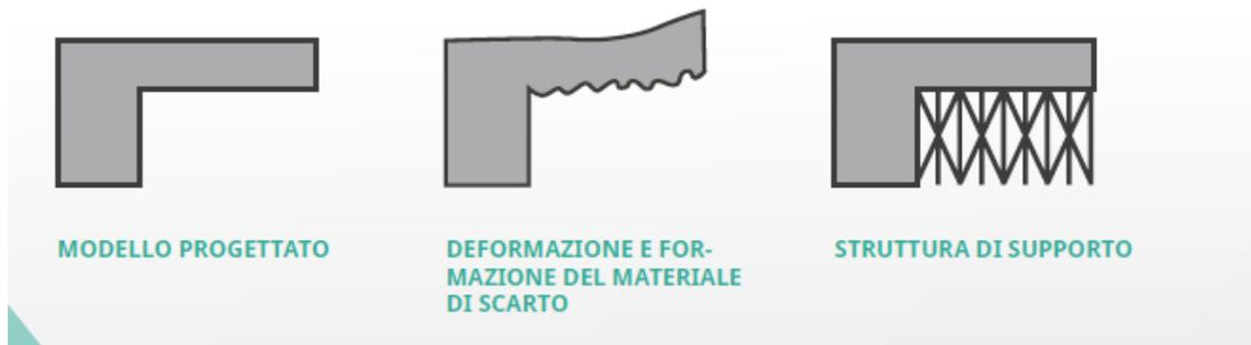
Figura 3.16 Uso di una struttura di supporto per una sporgenza. [4]
