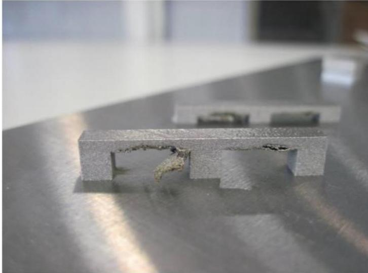
Figura 3.8 Esempio di cedimento di una struttura a ponte non supportata [20]
