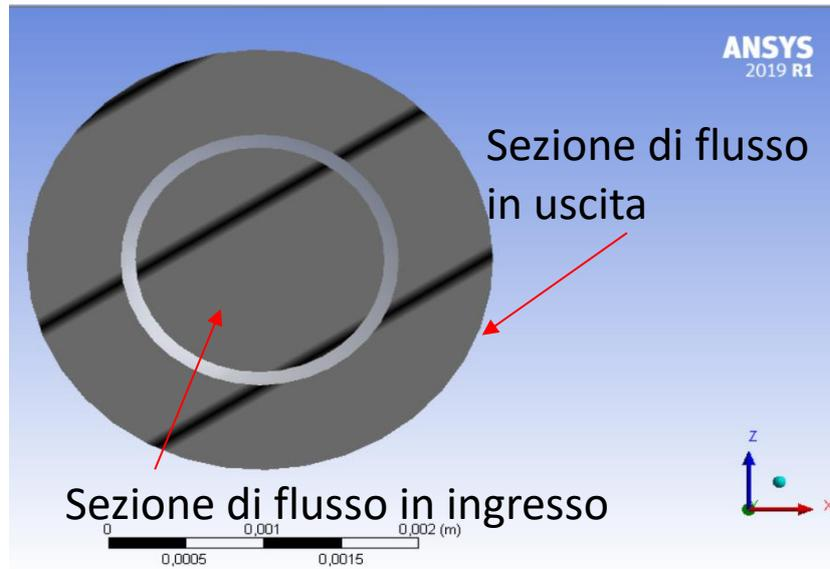
*Figura 35 – Sezioni del canale di raffreddamento*
