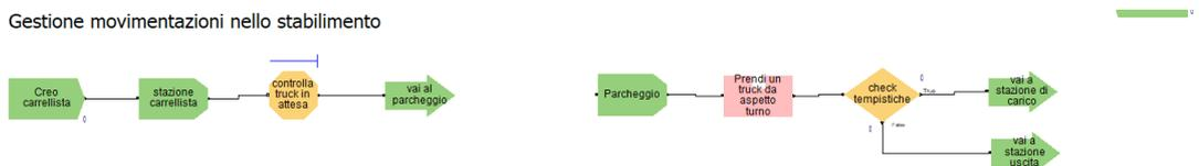
Figura 4.19: Gestione della movimentazione interna
