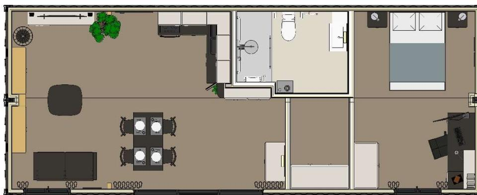
Figura 15 - Planimetria del modulo abitativo - Configurazione ad una camera
