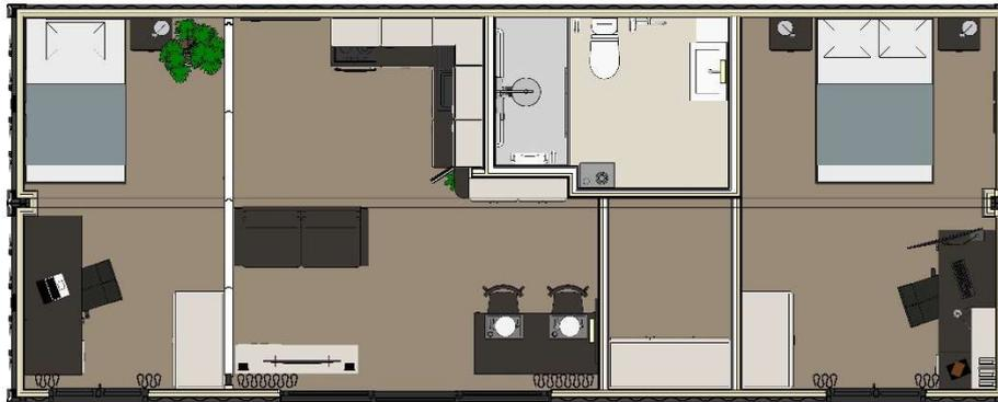
Figura 20 - Planimetria del modulo abitativo - Configurazione a due camere
