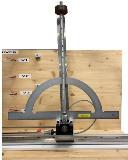
Figura 3.5 Taratura del trasduttore angolare
