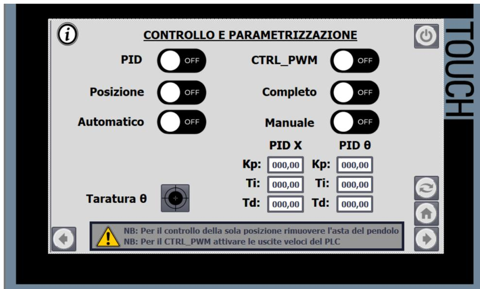
Figura 6.5 HMI: schermata per la scelta del metodo di controllo
