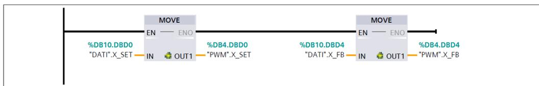
Figura 5.20 Segmento 1: importare i dati acquisiti
