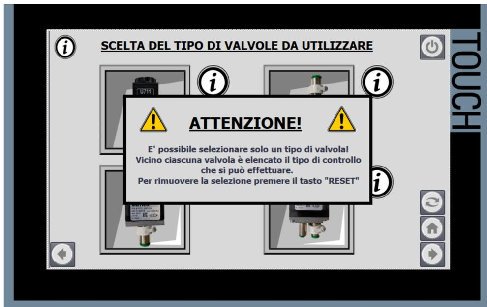
Figura 6.4 HMI: avviso scelta delle valvole errata
