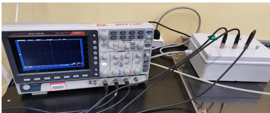
Figura 9 Sistema di acquisizione dati (oscilloscopio)
