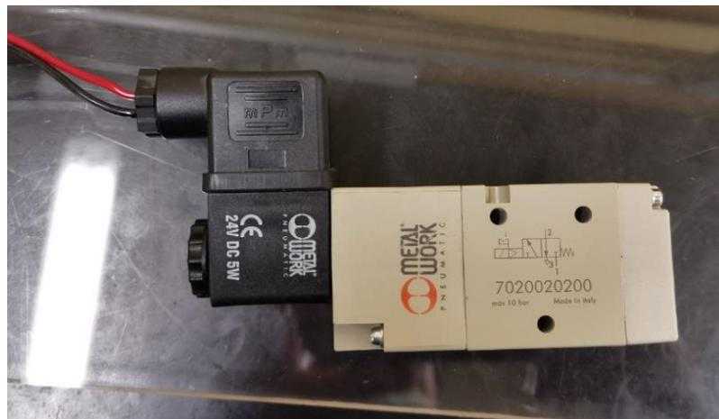
*Figura 21: Valvola di comando con solenoide*
