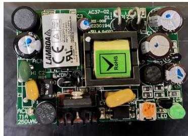
Figura 23: Alimentatore 5V dc per sensori di pressione
