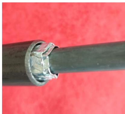
Figura 6.45 Dettaglio protezione superficie provino con calza d'alluminio
