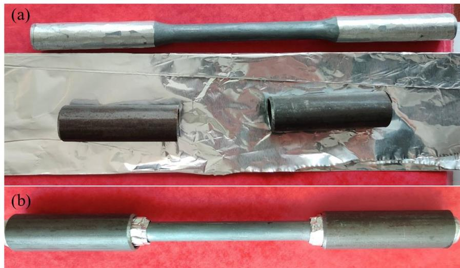
Figura 6.44 Preparazione provino per fatica assiale con inserimento calza alluminio e tubo d'acciaio. (a) set up iniziale (b) provino finito
