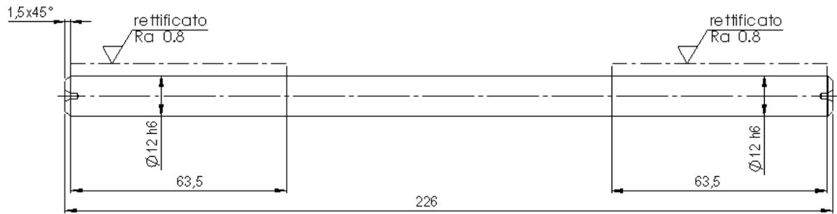
Figura 6.15 Disegno provino taratura  $\Phi=12$  mm costante
