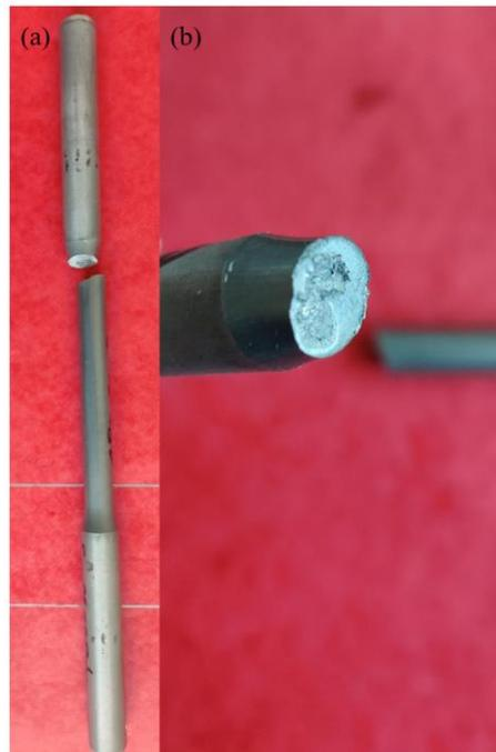
Figura 6.38 Rottura provetta fatica flessione rotante nel raccordo. (a) provetta rotta (b) dettaglio superficie frattura raccordo
