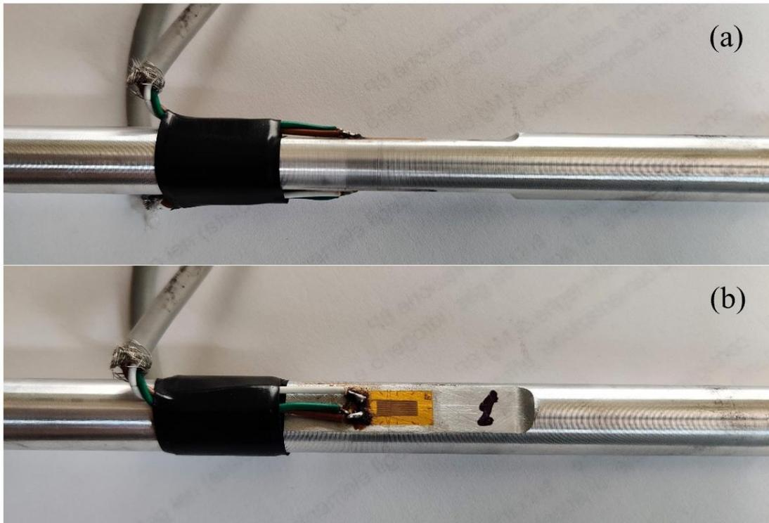
Figura 6.27 Campione lavorato per ospitare gli strain gauges
