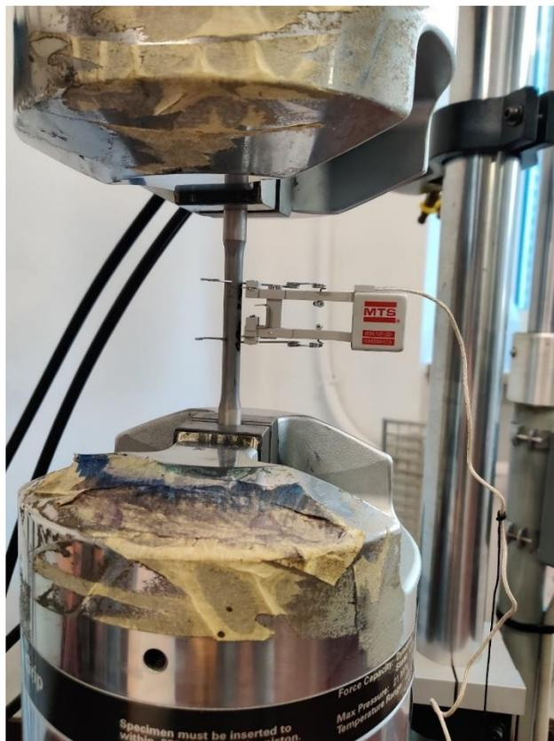
Figura 5.1 Set up sperimentale prova di trazione. Provino montato in MTS con estensimetro
