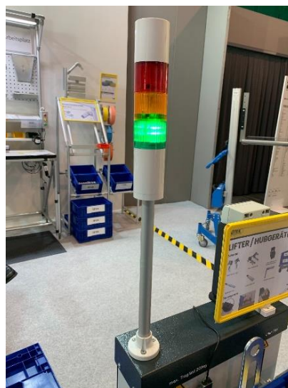
Figure 14 _Esempio di sistema Adon con colonnina luminosa
