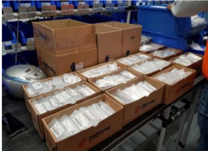
Figure 20 _Kitting secondario: ogni scatola è un kit
