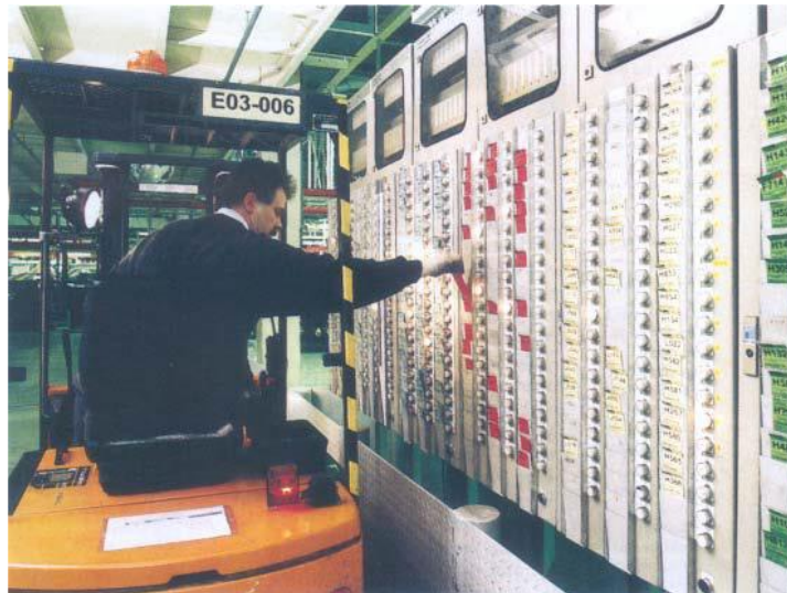
Figure 9_Esempio di rastrelliera kanban
