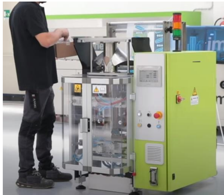
Figure 33_ Confezionatrice verticale con stampa diretta su film
