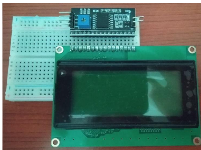
Figura 97 - LCD con interfaccia I2C
