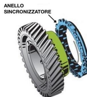
Figura 30 - Anello sincronizzatore, in blu (Fonte:[s.3])
