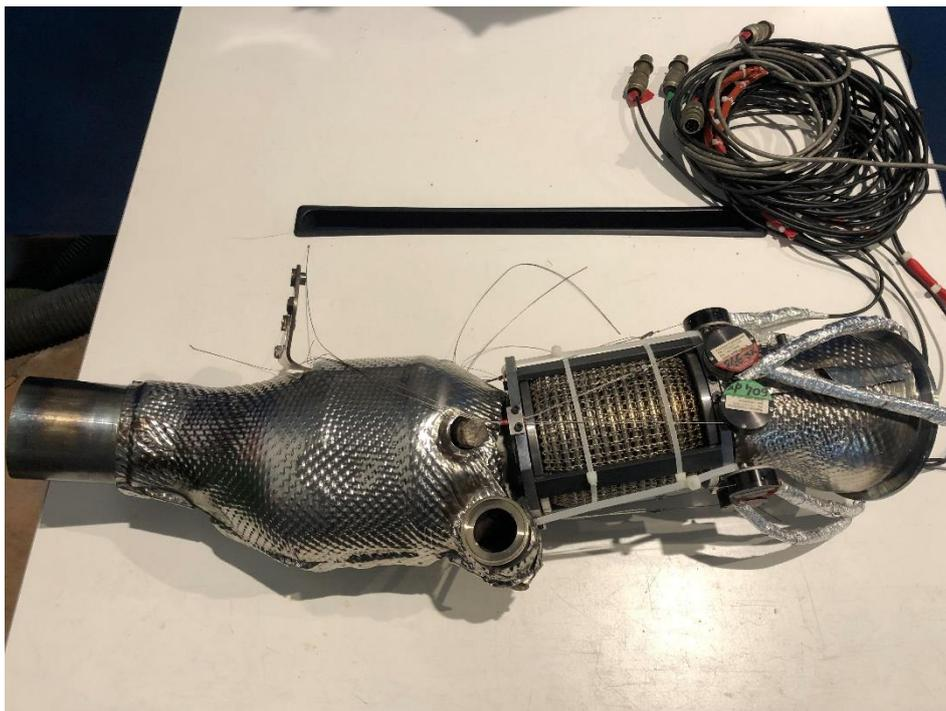
Figura 24: Rappresentazione installazione sensori Ferrari
