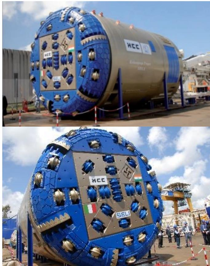
Figura 2.23 Double Shield Universal TBM impiegata nel tunnel Kishanganga (SELI Overseas)
