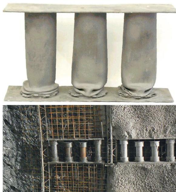
Figura 2.14 Elementi deformabili di prima generazione (in alto) e LSC (in basso) (Schubert 2017)
