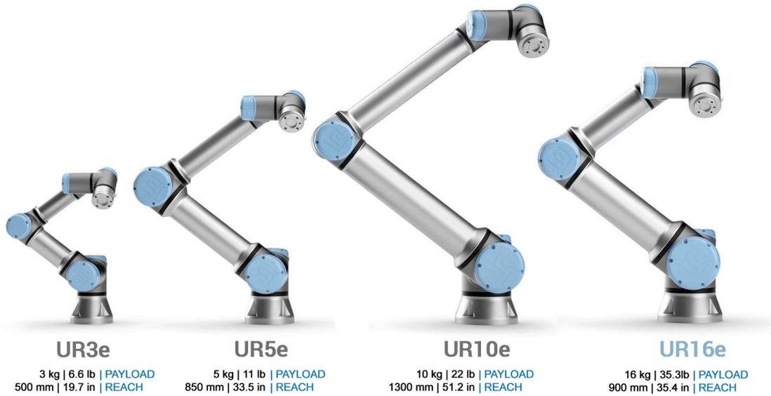
**Figura 2.1:** Modelli di cobot della Universal Robots [20].
