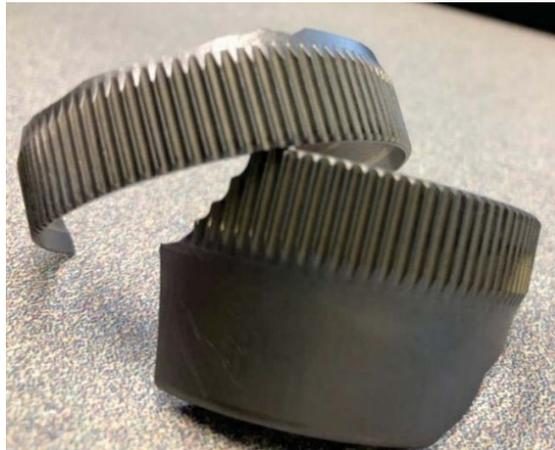
**Figura 3.15:** Rottura catastrofica di una Flexspline [73].
