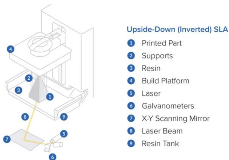
Figura 2 - Rappresentazione grafica dei meccanismi di base della stampa 3D stereolitografica.
