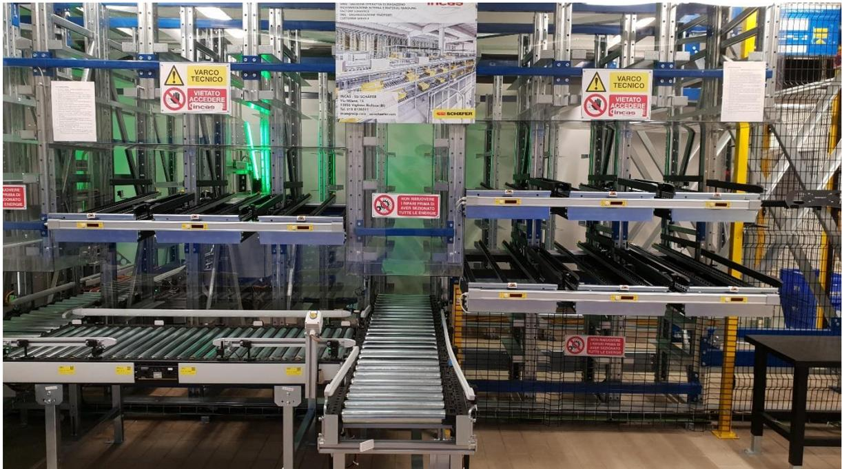
**Figura 4.3** – A sinistra stazione di kitting e a destra stazione di picking
