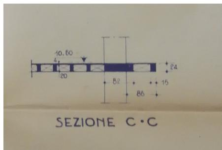
Figura 4.3: Sezione tipo solaio e travi
