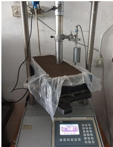
*Figura 53 -Prova per la valutazione del CBR della lastra*
