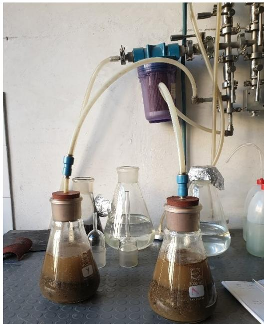
*Figura 36 - Metodo del Picnometro per la determinazione della massa volumica del materiale passante al 31,5 mm*
