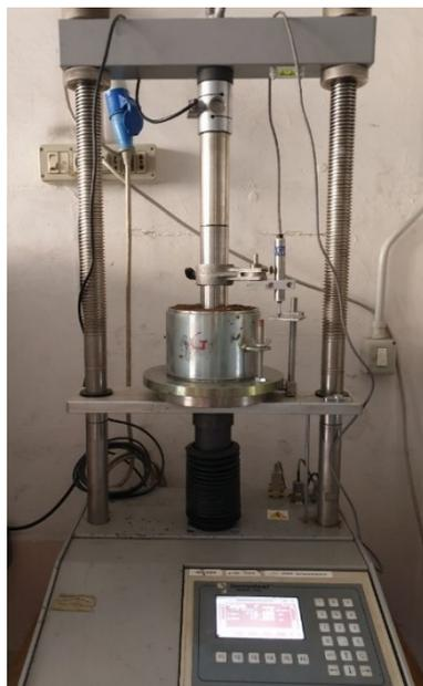
*Figura 37 - Prova per la determinazione dell'indice CBR*
