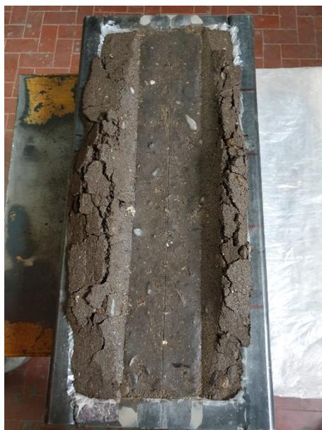
Figura 57 – Lastra al termine delle 100 passate, preparata con materiale F029 con CBR ipotizzato nel range normativo
