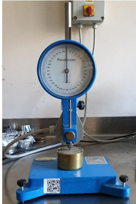
*Figura 31 - Penetrometro utilizzato per determinare il limite liquido*
