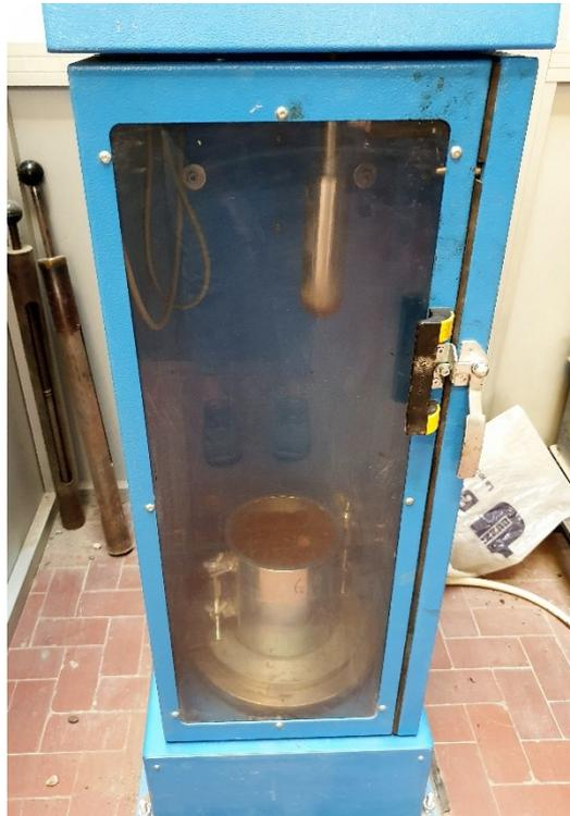
*Figura 33 - Macchina utilizzata per la prova Proctor*
