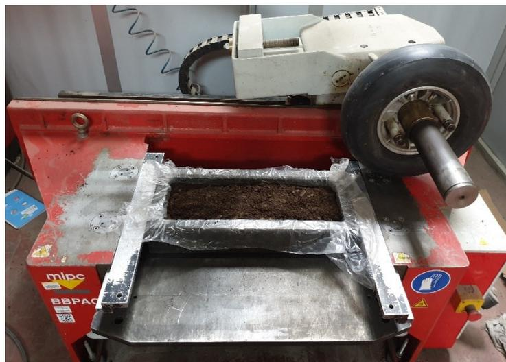
*Figura 52 - Compattazione del materiale*
