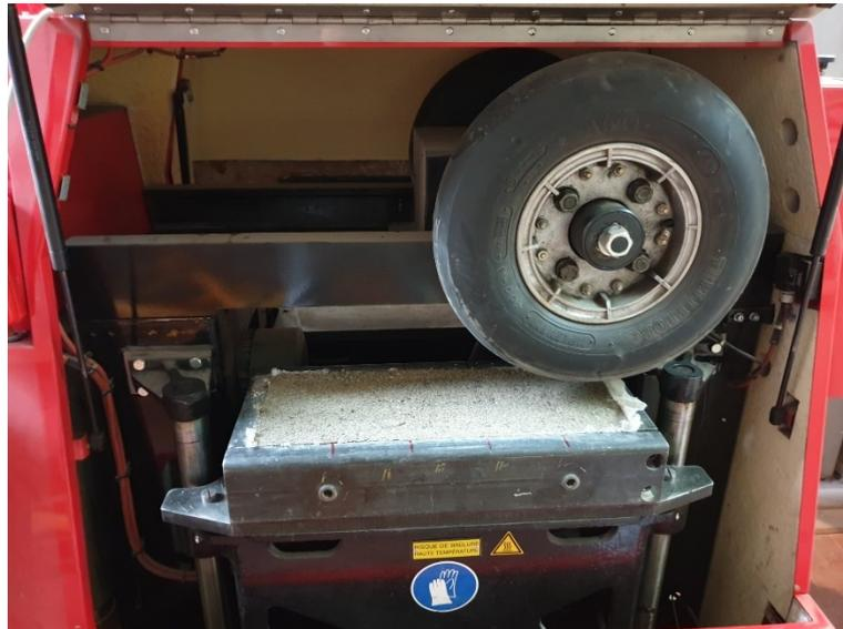
Figura 50 - Macchina ormaiatrice con lastra di materiale pronta per la prova
