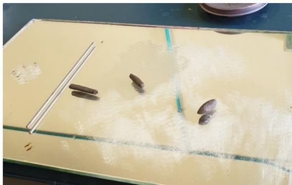
*Figura 32 - Prova per la determinazione del limite plastico terreno F029*
