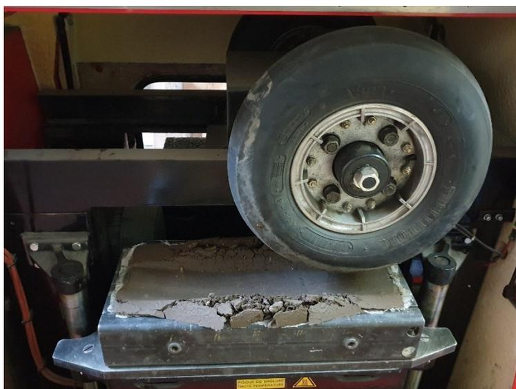
*Figura 55 - Foto esempio della lastra al termine della prova con 100 passate<sup>14</sup>*
