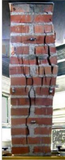
**Figura 4\_** Rottura per schiacciamento di una colonna in muratura
