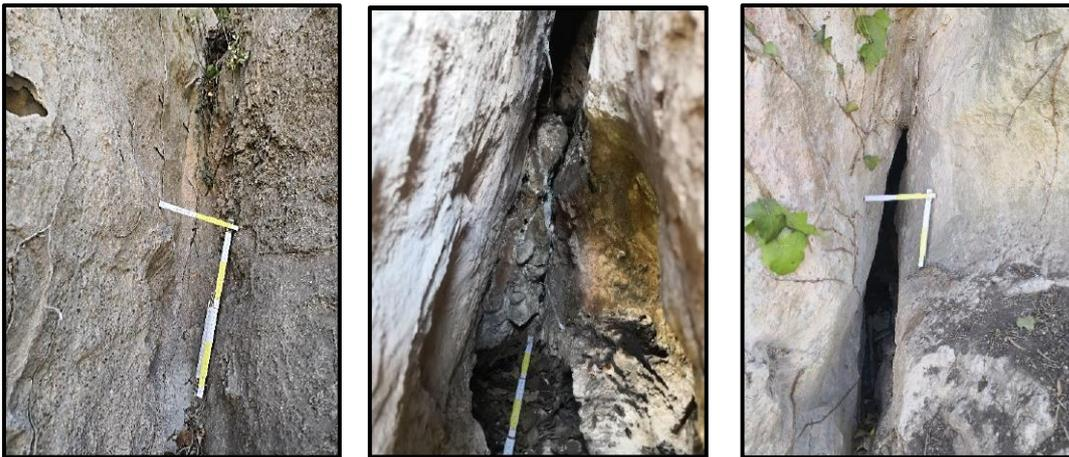
Figura 4.11 A discontinuità interessata da filtrazione e ponti di roccia
