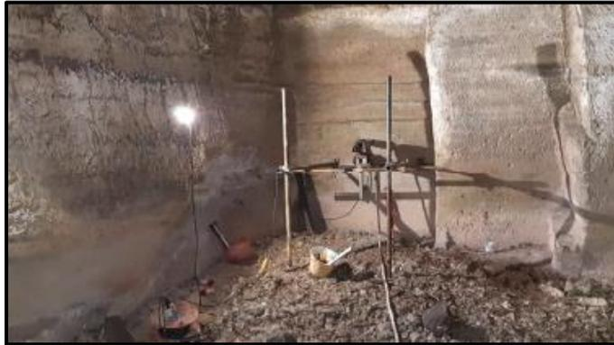
*Figura 3.4 Realizzazione foro di sondaggio S3*
