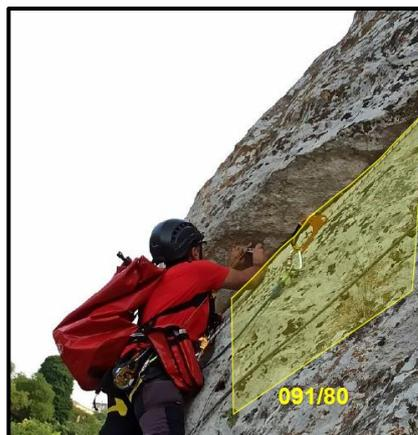
*Figura 4.21 Superficie di scivolamento del masso 4*
