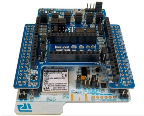
Figura 6.8: X-Nucleo-IKS01A3 connessa alla board Nucleo-WB55RG
