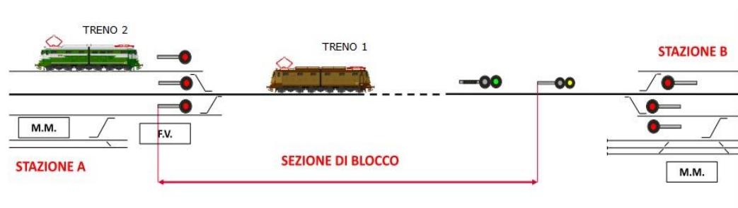
Figura 18 - Principio di distanziamento. Il treno 2 non vede il segnale di via libera in quanto il treno 1 sta occupando la sezione di blocco a valle
