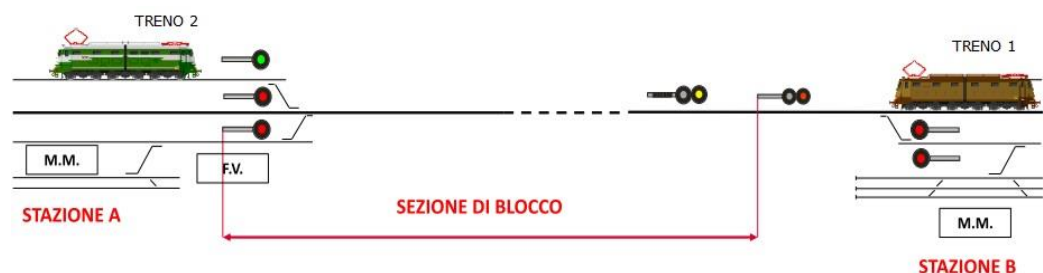
Figura 18 - Principio di distanziamento. Il treno 2 non vede il segnale di via libera in quanto il treno 1 sta occupando la sezione di blocco a valle
